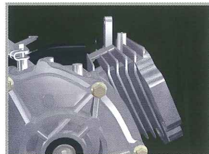
Verlängerte Kühlrippen am Zylinder
